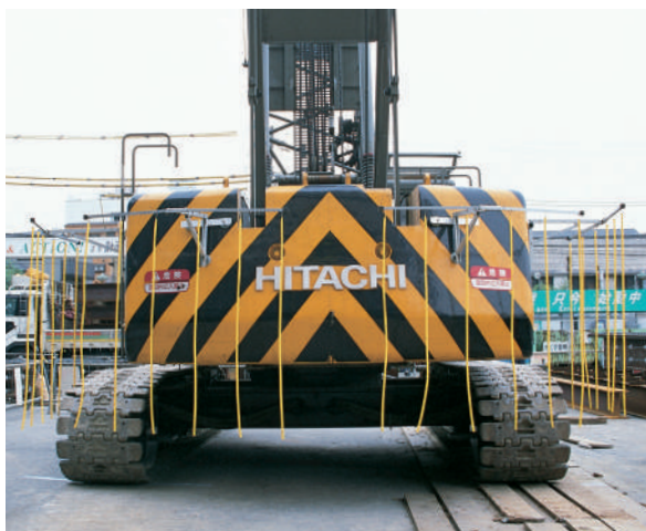
参考:両端部は人が通り抜けできない程度の間隔(50~60cm)にし、チューブの下端が地上高1m程度。
