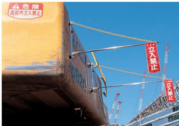
重機の周囲にスペースを確保し、作業員が旋回する重機にはさまれないよう、事故を未然に防ぐための装置です。万が一、作業員が危険区域に入った場合、本機が先に接触することにより、その作業員は直接、警告を体感します。
