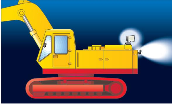
パノラマオーは、重機の後端部等の立入禁止区域内において、作業員が事故に遭遇するのを未然に防止する装置です。超音波センサーが検知エリア内の人や物体を検知して、スピーカーから音声（女性の声）による警告を発します。同時にオペレーターにも電子音で注意を促します。
