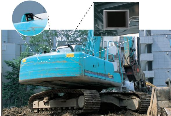
パノラマアイは、CCD カメラを重機（車両）の後部に取り付けることによって、運転席のカラーモニターで後方の安全を確認し、事故を未然に防ぐ装置です。
