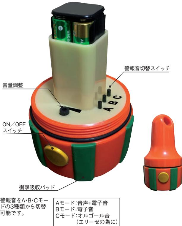
可变的に警告音量を調整することが出来ます。閑静な住宅街など作業現場状況に合わせて音量調整と警告音の切り替えが可能です。
