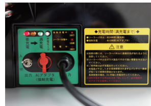
ソーラー電源ユニットにはバッテリーインジケーターがついており残量の確認ができます。
