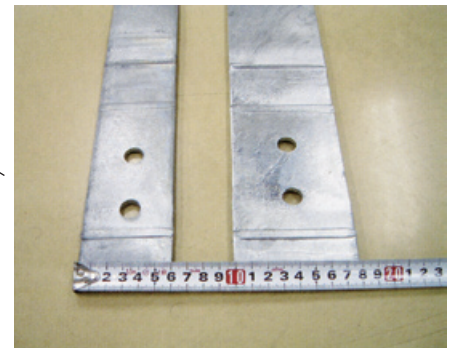
【ストリップ (補強材)】 (右) 幅広ストリップ SS400 ← (使用補強材) 4.0mm (厚) × 80mm (幅) × L (長さ) (左) 従来ストリップ SM490A 4.0mm (厚) × 60mm (幅) × L (長さ)
