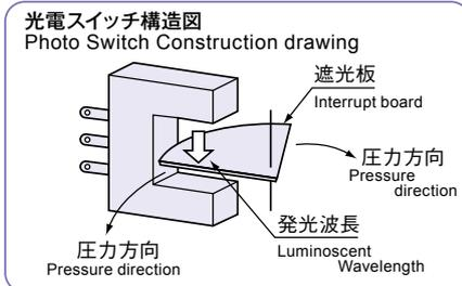
光電スイッチ付圧力計は弊社の高精度圧力計内に超小型光電スイッチ（マイクロフォトセンサー）を組み込んだ非接触型圧力スイッチです。
