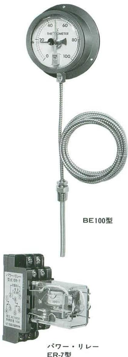
接点付温度計は精度の高い指示計にコンタクト接点機構を組込んだ製品で、微少な温度変化にも敏感に作動通電しますので、警報用、制御用温度スイッチとして広範囲な用途が有ります。
