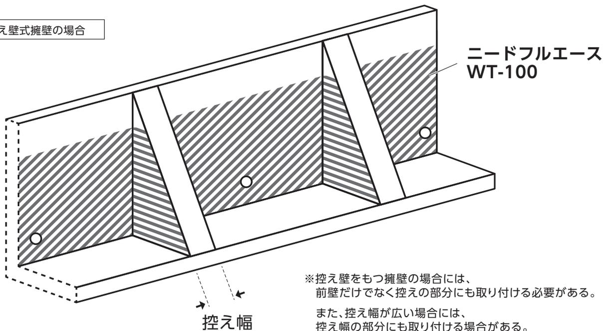
※控え壁をもつ擁壁の場合には、前壁だけでなく控えの部分にも取り付ける必要がある。
