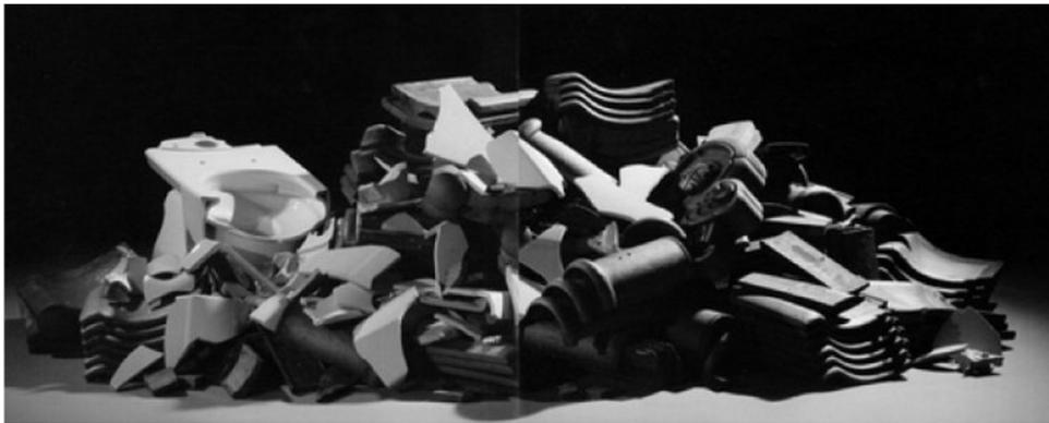
●骨材となる規格外品の衛生陶器、廃瓦
