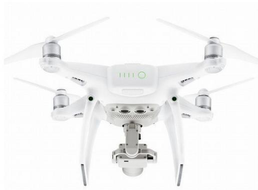
機体の本体にチタン合金とマグネシウム合金構造を採用して敏捷性を高め、軽量化されたPhantom 4 Proの重量は、Phantom 4と同程度に抑えています。
