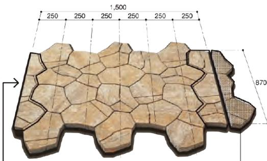
コーナーパーツを両サイドに使用し、間に入るティーナの数を増やすことで、250mm ピッチで幅を調整することができます。※片側だけの施工の場合は、片側半分はお使いいただけませんのでご了承ください。
