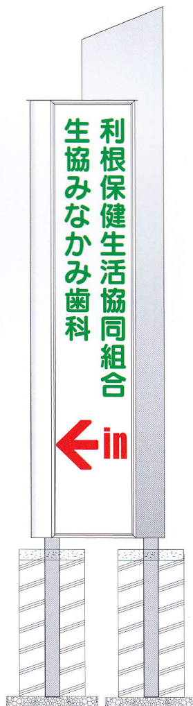
ステンレス板にカッティング文字を使用した看板施工
