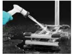
IP規格とは、国際電気標準会議 (IEC) が定めた電機機器内への異物や水の侵入に対する保護規格。防塵性能・防水性能に関する保護等級である。
