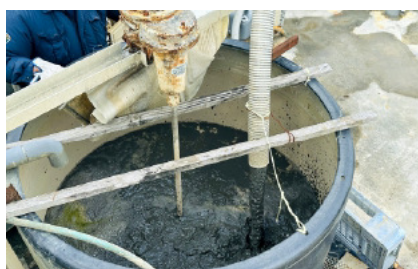
汚泥凝集中（スラリー化）
