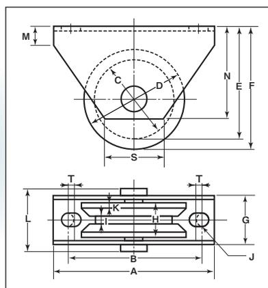
※枠の材質はSUS304、シャフトの材質はSUS303。
