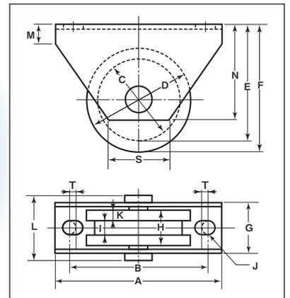
※枠の材質はSUS304、シャフトの材質はSUS303。
