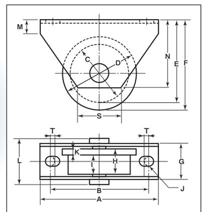
※枠の材質はSUS304、シャフトの材質はSUS303。
