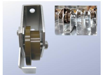
お客様から送っていただいた写真と寸法をそっくりそのまま再現しました。枠はSUS304、車輪は鉄S45Cを切削で直径118mmのトロ車型に加工しました。某大学の門扉に使用されます。
