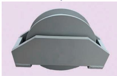
この戸車はお客様から頂いたサンプルの寸法を計測し、そのまま再現いたしました。また、300kgほどのスチール製扉に使用されるとのことので枠の一部などを溶接で製作し、丈夫な構造になるようにいたしました。このように寸法を計測しサンプル通りに再現し製作することも可能です。
