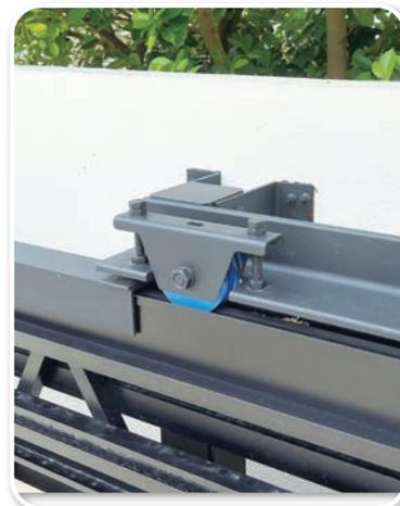
おしゃれな門扉の戸車に“MC防音重量戸車440Cベアリング組み換え品”をご使用いただきました。従来のレールの上を走らせる仕様の門扉ではなく、MC防音重量戸車で扉の上下を挟み込み、その間を滑らせることで、レールがいない仕様の門扉を製作しておられます。MCナイロン製の戸車をご使用になる事で、開閉音の低減、MCナイロン自身の自己潤滑性でスムーズな開閉を実現できたのではないかと思います。お客様からは音もなく荷重にも耐え素晴らしいとの感想をいただきました。
