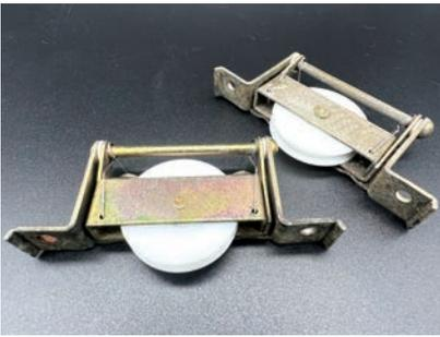
エアータイト戸車の車輪（材質：POM）のみ製作し、既存の枠に取り付けいたしました。車輪が破損や摩耗などで寿命を迎えたため製作依頼をいただきました。
