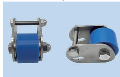
樹脂系車輪が使用されている戸車を枠ごと交換しました。枠の曲線を描くフォルムや、穴の位置を同じように設計するのが難しい商品でしたが、ヨコヅナならではの経験と技術によって見事に再現する事ができました。車輪は、既製品が大きく摩耗している状態でしたので、ナイロン系の材質の中でも、機械強度が高く、耐摩耗性に優れた「MCナイロン」という材質を使用して、新しい車輪を製作しました。
