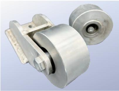
車輪の中に入っているベアリングが破損したため交換してほしい…というご依頼があり製作いたしました。枠はそのまま使用して車輪のみ製作しベアリングを2個入れて耐荷重も十分です。
