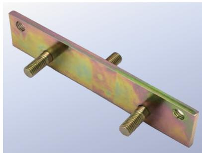
「吊り戸車」の吊り元の金具です。大型で重量のある扉の、吊り用の戸車に使用していましたが、扉を外す際に突起の内1本が折れてしまったとの事で、今回この金具部分を製作しました。
