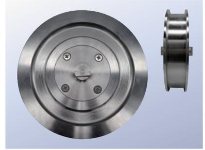
車輪の別注品製作です。車輪とシャフトは全てSUS316、車輪径Φ220mm、ベアリング#440Cの錆びにくい仕様になっております。
