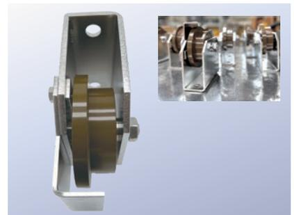
お客様から送っていただいた写真と寸法をそっくりそのまま再現しました。枠はSUS304、車輪は鉄S45Cを切削で直径118mmのトロ車型に加工しました。某大学の門扉に使用されます。
