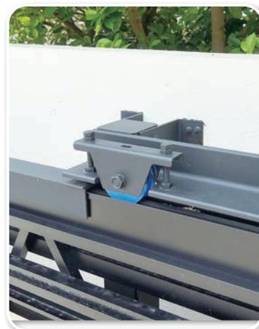
おしゃれな門扉の戸車に“MC防音重量戸車440Cベアリング組み換え品”をご使用いただきました。従来のレールの上を走らせる仕様での門扉ではなく、MC防音重量戸車で扉の上下を挟み込み、その間を滑らせることで、レールがいない仕様での門扉を製作していただけます。MCナイロン製の戸車をご使用になる事で、開閉音の低減、MCナイロン自身の自己潤滑性でスムーズな開閉を実現できたのではないかと思います。お客様からは音もなく荷重にも耐え素晴らしいとの感想をいただきました。
