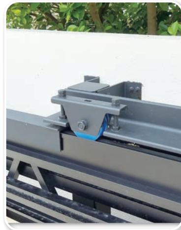
おしゃれな門扉の戸車に“MC防音重量戸車440Cベアリング組み換え品”をご使用いただきました。従来のレールの上を走らせる仕様の門扉ではなく、MC防音重量戸車で扉の上下を挟み込み、その間を滑らせることで、レールがいらない仕様の門扉を製作しておられます。MCナイロン製の戸車をご使用になる事で、開閉音の低減、MCナイロン自身の自己潤滑性でスムーズな開閉を実現できたのではないかと思います。お客様からは音もなく荷重にも耐え素晴らしいとの感想をいただきました。
