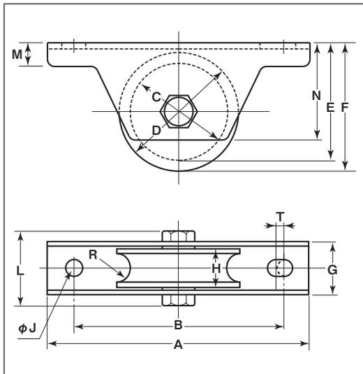
※枠、ボルトの材質はSUS304、車の材質はSUS303です。
