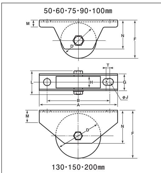
●シャフト部はカシメ加工ができます。通常ボルト・ナット締め以外にシャフト部分のカシメ加工もできます。(50mm~100mm)
