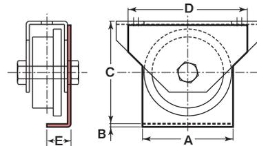
※使用されるレール幅の3/3以上車輪幅(h)がくるように使用してください。
