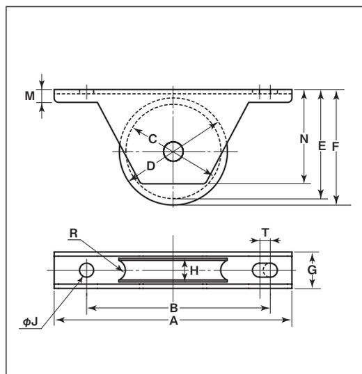
※枠、軸の材質はSUS304、車の材質はSUS303です。
