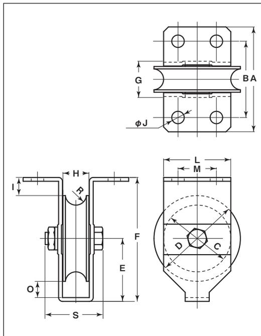
※枠、軸の材質はSUS304、車の材質はSUS303です。
