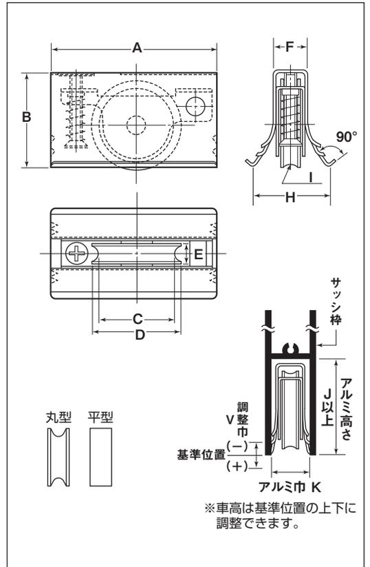
アルミ高さJ寸法がB寸法以上ある場合は落ち込まないようにスペーサーを入れてください。戸車が移動しないようにネジ止めしてください。
